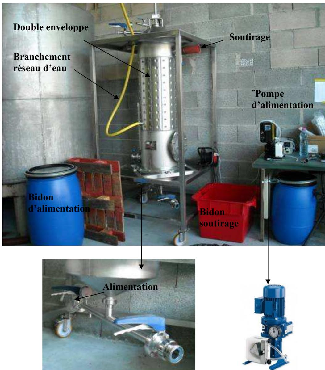
Figure 61 : Photo du montage expérimental pilote (170 L)
