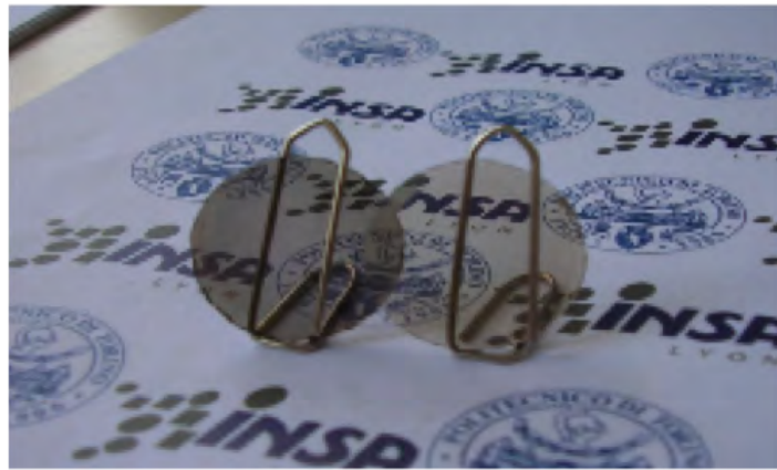
Figure 1.14: Echantillons de YAG frittés par SPS avant (gauche) et après (droite) traitement de réoxydation sous air [SPI 12]
