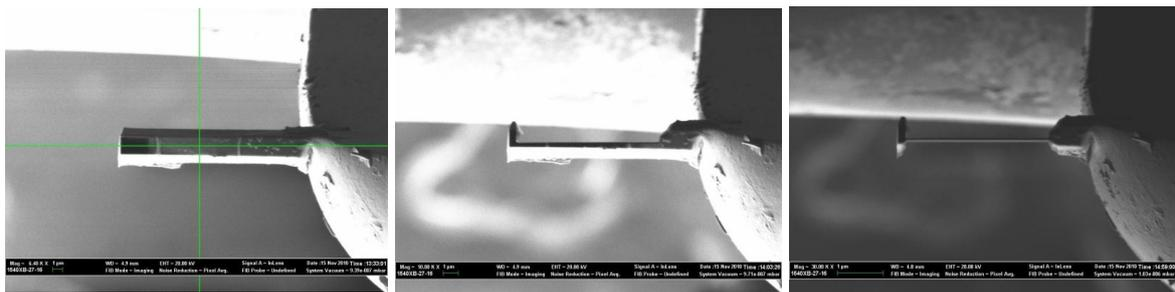
Figure IV. 29 : Images FIB de l'amincissement progressif d'une lame prélevée sur un transistor TCC de la série 8-1k, dont l'épaisseur passe de  $2 \mu\text{m}$  à 50 nm
