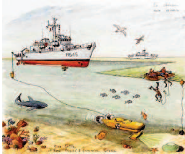
FIGURE 1.10 – Scénario actuel de guerre des mines [35]. Une mine est présente en bas à droite de l'image. Le bateau représente le CMT qui détecte la mine, le ROV la classe et le plongeur la désarme.
