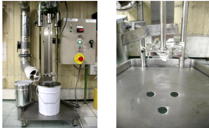
Figure IV.5. Système de mélange utilisé pour la préparation des pâtes en pilote BMC : disperser / seau de 5L.
