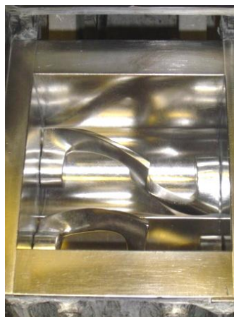
Figure IV.6. Malaxeur de type bras en Z utilisé pour la mise en œuvre des compounds BMC à l'échelle pilote.
