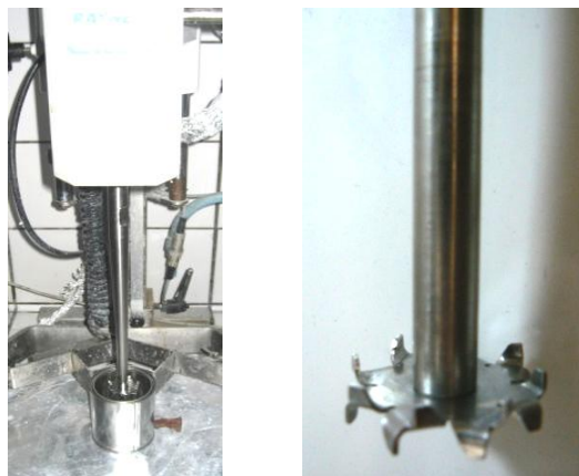
Figure IV.2. Système de mélange utilisé au laboratoire : disperser / pot de 250 mL.
