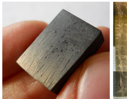
Figure 2.6: Bloc (à gauche) et allumette (à droite) polis de NB31 prêts à être implantés et analysés
