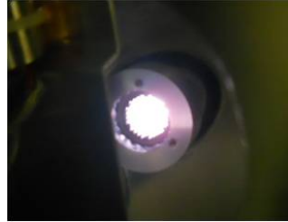
Figure 2.11: Plasma de deutérium visible à travers les grilles d'extraction lors du fonctionnement de la source
