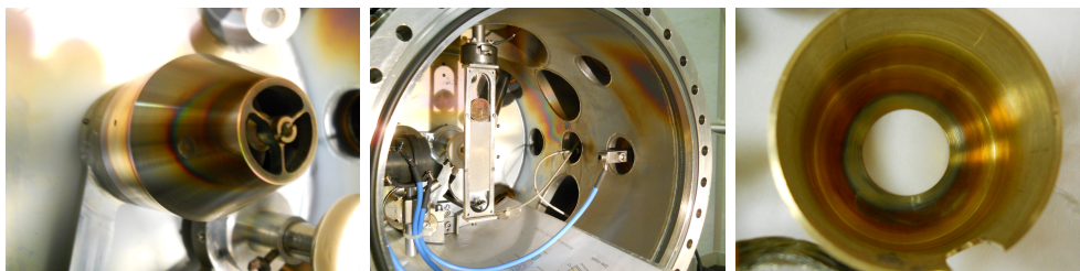
Figure 2.20: La pollution de la chambre d'analyse (à gauche sur le collimateur, au centre sur la paroi de la chambre d'analyse) et le collimateur conçu et mis en place sur la lentille afin d'empêcher ces dégradations (à droite).
