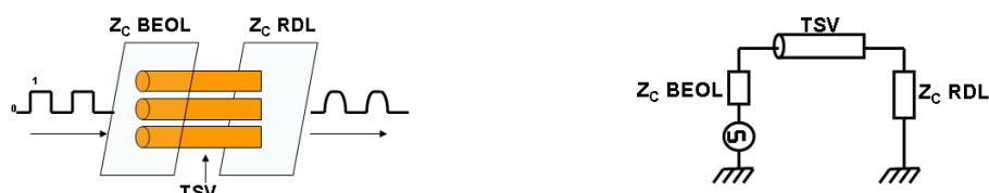
figure 4- 10: Illustration du contexte et du principe de l'étude: (a) représentation simplifiée des circuits impliqués, (b) schéma électrique associé
