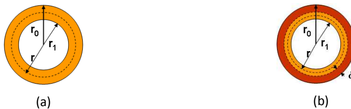
figure 3-3 : Représentation de la répartition du courant dans un conducteur creux : (a) TSV en statique ; (b) TSV avec effet de peau
