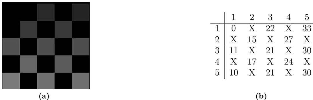
**Figure II.32.** Carte de décalage local. (a) hologramme additionné au damier d'adressage, le contraste a été augmenté. (b) carte des valeurs en niveaux de gris des décalages locaux. Les cases noires sont marquées par des X.
