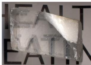
**Figure I.22.** Double réfraction dans un cristal de calcite. Deux directions de polarisations orthogonales ne voient pas le même indice optique et ne sont donc pas déviées avec le même angle de réfraction, d'où les deux images. (photo d'Adrian Pingstone, Mai 2003)
