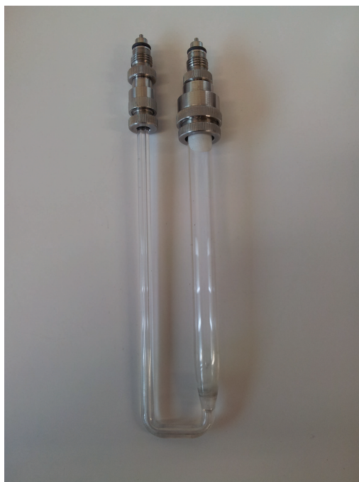
Figure B.9 – Réacteur avec système de fermeture hermétique
