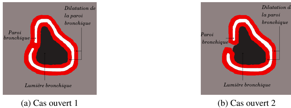
FIGURE 3.5 : Schématisation de deux cas d'une configuration de dilatation morphologique de la paroi bronchique R_{pb'} , de type ouverte : (a) la dilatation ferme le trou dans la paroi, mais il n'existe plus de séparation entre paroi interne et externe,(b) ouverture totale.
