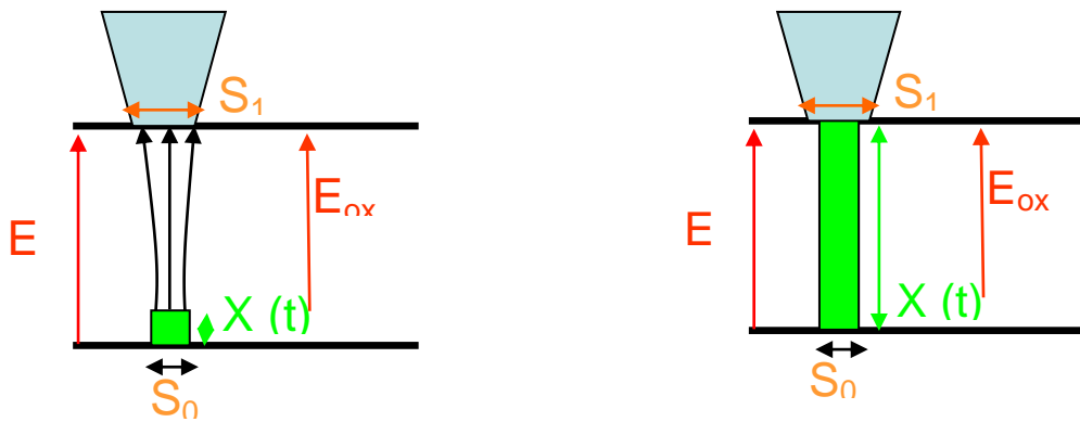
Figure 4.9 : Schéma de principe montrant la croissance filamentaire dans l'oxyde poussée jusqu'à la rupture. E_{ox} augmente avec la longueur du filament X(t) donnée dans l'équation 4.7 et atteint sa valeur maximale qui correspond à t_{ox} (droite).
