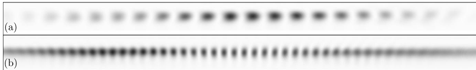
FIGURE 3.29 – Images des franges d'une jonction-Y d'un écart d_Y = 100 \mu\text{m} au dessus (a) et d_Y = 220 \mu\text{m} en dessous (b)
