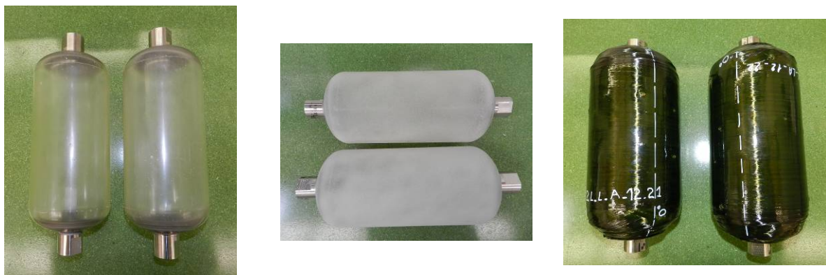
Figure 174 : Liners époxy rotomoulés, sablés puis bobinés
