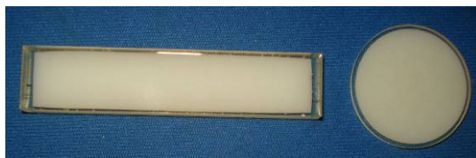
Figure 80 : Migration observée lors de la réticulation du système DER 332 Jeffamine D400 modifié par 5 pcr de PEI
