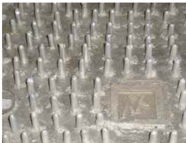
Figure 36 : Ailettes installées sur la surface externe du moule pour augmenter l'épaisseur de polymère adhérent (voie fondue)
