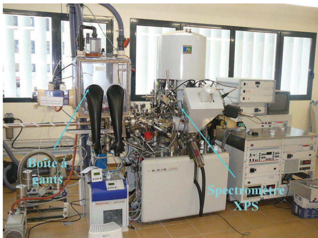
Figure 2-1 : Boîte à gants directement reliée au spectromètre XPS.
