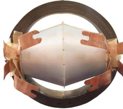
Figure 140 : Photographie du transformateur résonant impulsif
