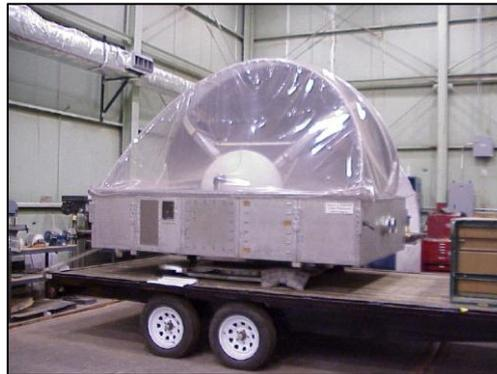
*Figure 29 : Photographie du système JOLT dans son ensemble (diamètre de l'antenne : 3,05m)*
