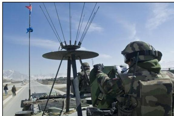
*Figure 10 : Brouilleur anti-IED sur un véhicule militaire*
