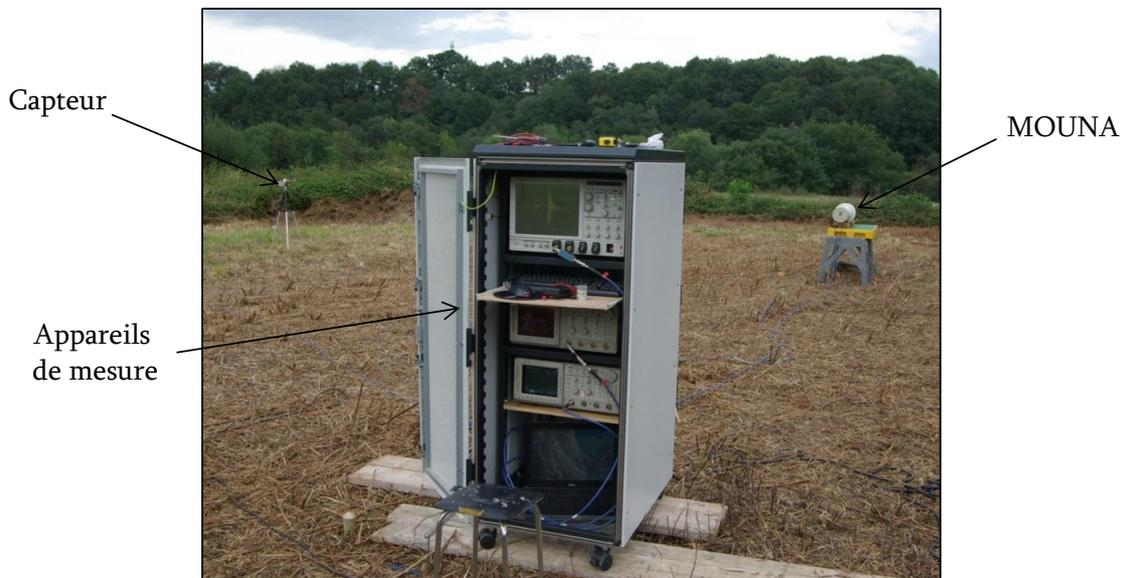
Figure 187 : Photographie du dispositif expérimental de test de la source autonome
