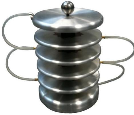
Figure 126 : Photographie de la réalisation du condensateur
