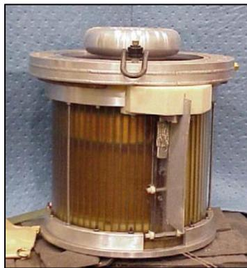
*Figure 30 : Photographie du transformateur 1MV intégré dans JOLT*
