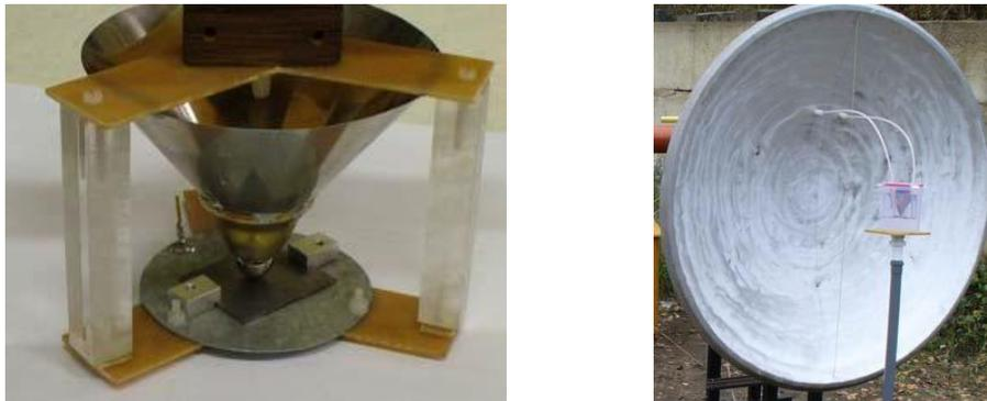
*Figure 11 : Design de l'éclateur, du cône et du réflecteur*
