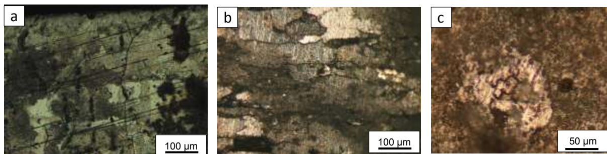
Figure IV-47: Observations au microscope optique dans le plan L-TL (a) du métal de base, (b) de la ZAT et (c) du noyau soudé du joint soudé T34 OPT après un essai de corrosion sous contrainte réalisé sur le joint soudé complet durant 3 jours dans une solution à 0,7 M de NaCl thermostatée à 25 °C.
