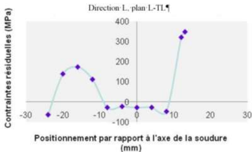
Figure IV-20 : Répartition des contraintes résiduelles suivant la direction L mesurées en réalisant une série de pointés selon la direction TL dans le plan L-TL du joint T34 OPT post traité.
