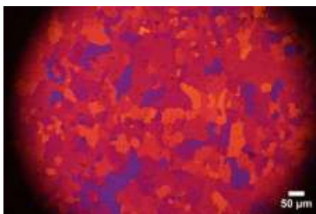
Figure IV-32 : Observation au microscope optique et en lumière polarisée après attaque électrochimique avec \text{HBF}_4 du métal de base AA 2050-T34 après laminage (taux de déformation de 250%) et traitement thermique (maintien de 1 minute à 400 °C).
