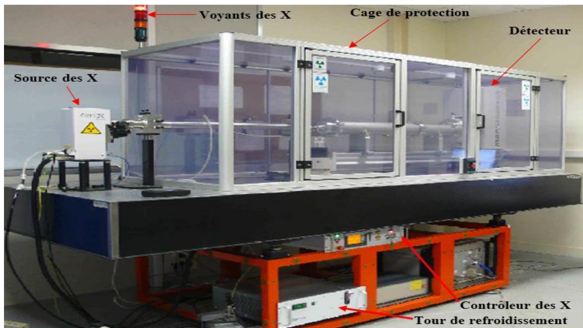
Figure 2.22 : Visualisation de l'ensemble du banc WAXS/SAXS.
