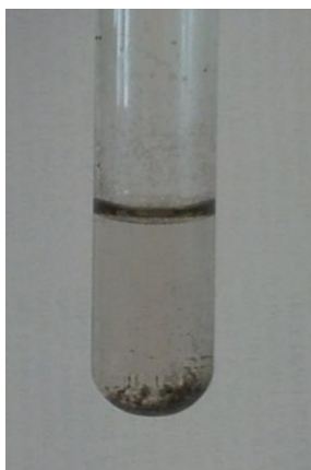
Figure I-17 : Solution de Pd(OAc) 2 (0,625 mmol/L) et d'acide phénylboronique (0,163 mol/L) dans l'eau (2 mL) après 24h
