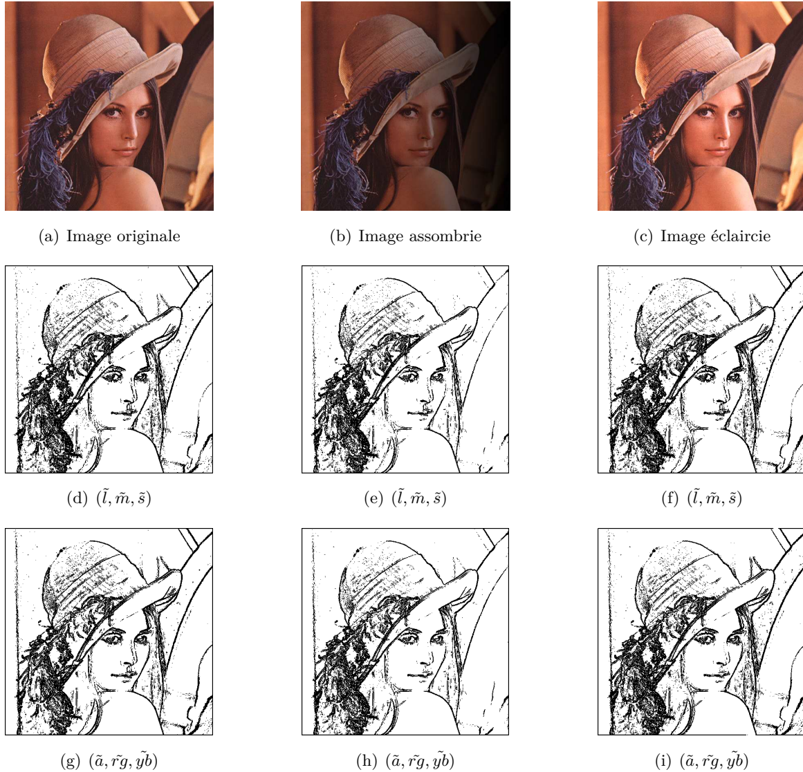
FIGURE 8.7 – Détection de contours à l'aide d'un gradient classique sur l'espace (\tilde{l}, \tilde{m}, \tilde{s}) , et sur l'espace (\tilde{a}, \tilde{r}g, \tilde{y}b) .
