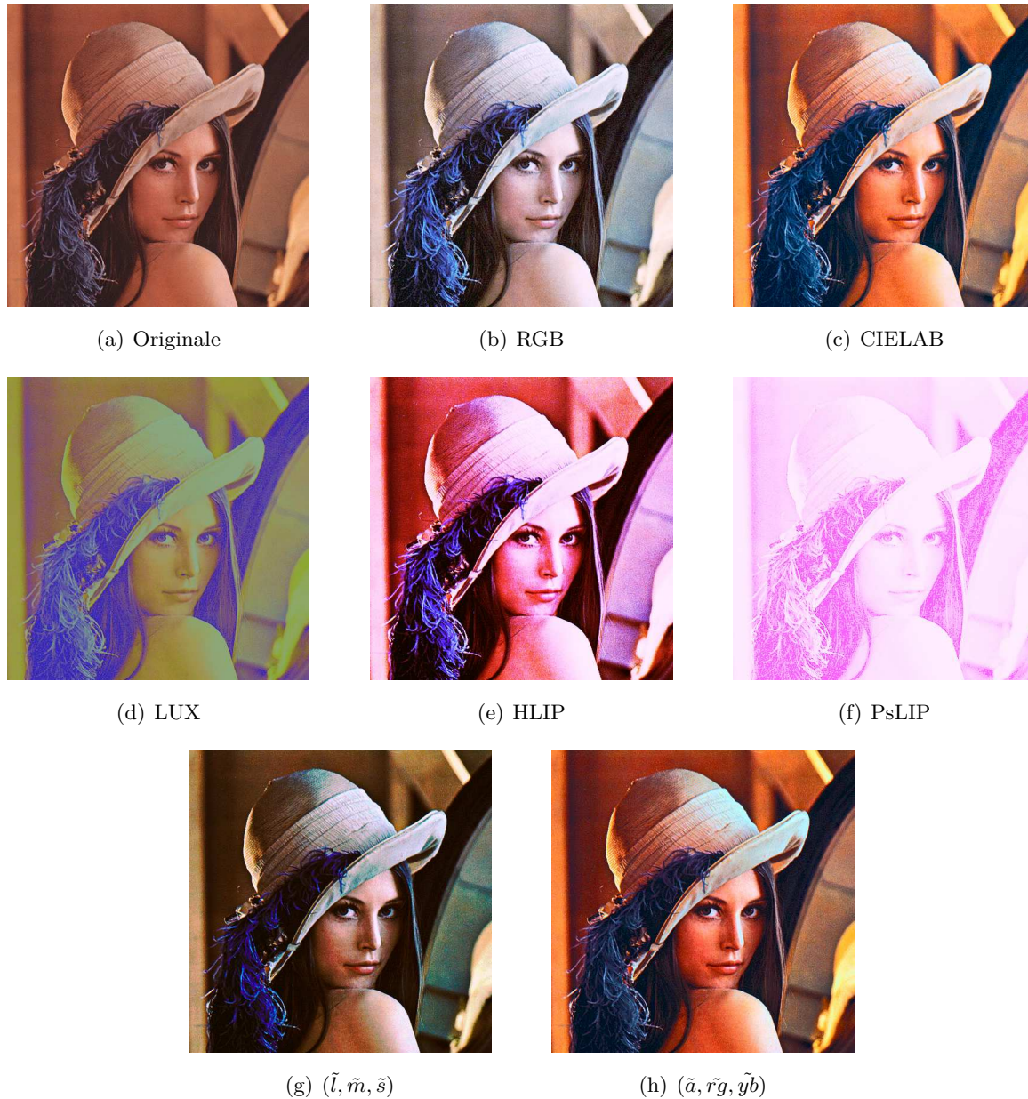
FIGURE 8.9 – Égalisation d’histogramme dans les espaces RGB, CIELAB, LUX, HLIP, PsLIP, (\tilde{l}, \tilde{m}, \tilde{s}) , et (\tilde{a}, \tilde{r}g, \tilde{y}b) .
