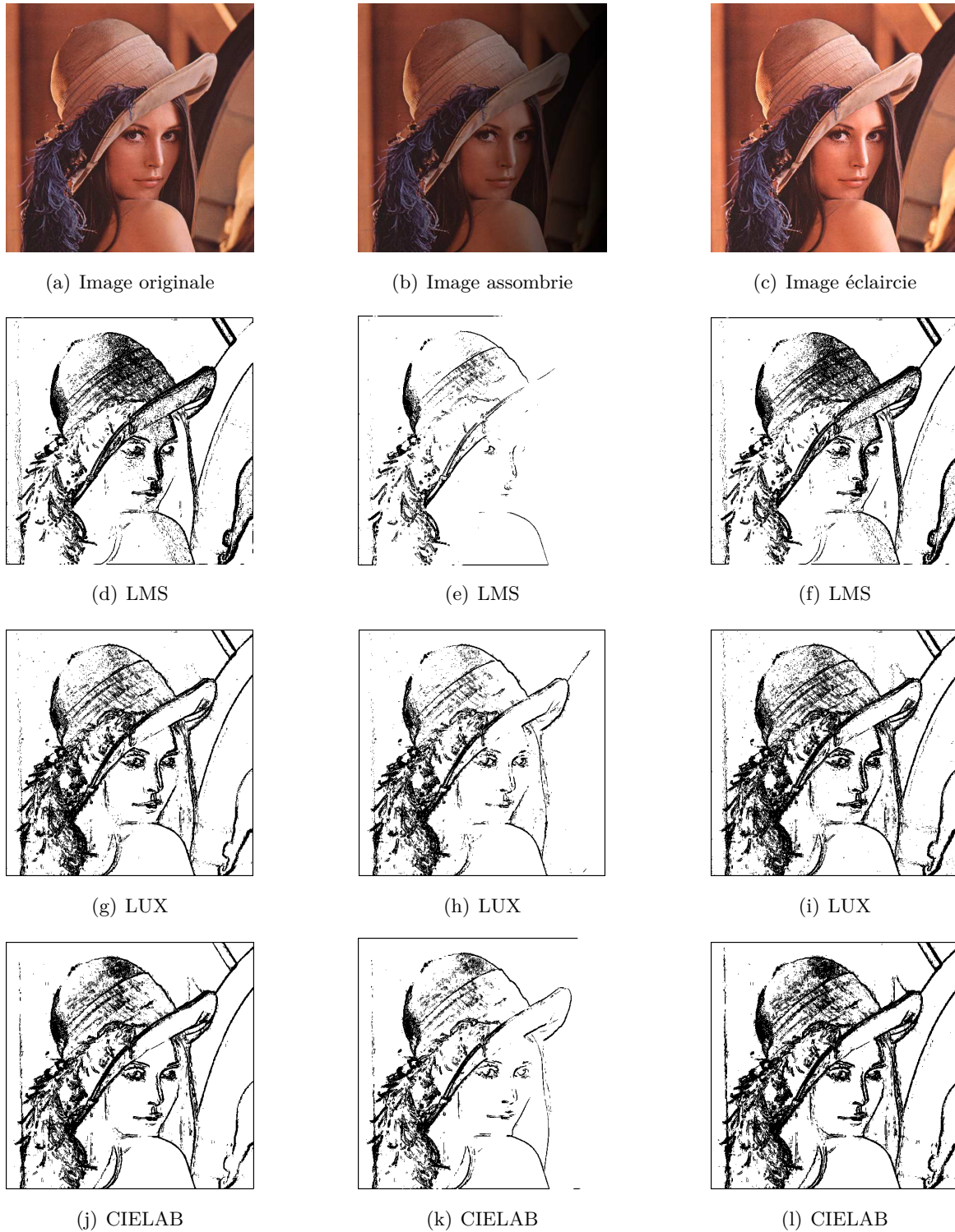
FIGURE 8.5 – Détection de contours à l’aide d’un gradient classique sur l’espace de réponse des cônes ( L, M, S ), sur l’espace LUX, et sur l’espace CIELAB.
