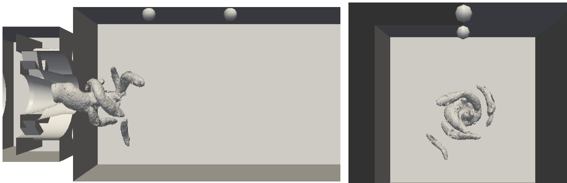
FIGURE 9.2 – Isocontour de pression P = 103\,000 Pa matérialisant l'instabilité PVC, à l'instant t_0 . Bougies à z = 56 mm et z = 116 mm.
