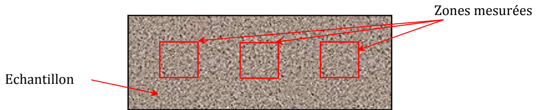
Figure II. 17. Représentation schématique des zones mesurées en utilisant l'interférométrie optique. L'échelle n'est pas respectée.
