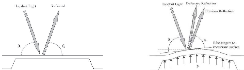
Figure 2.10 : Déflexion de la membrane (a) sans et (b) avec application de pression (Kohl et al., 2005)
