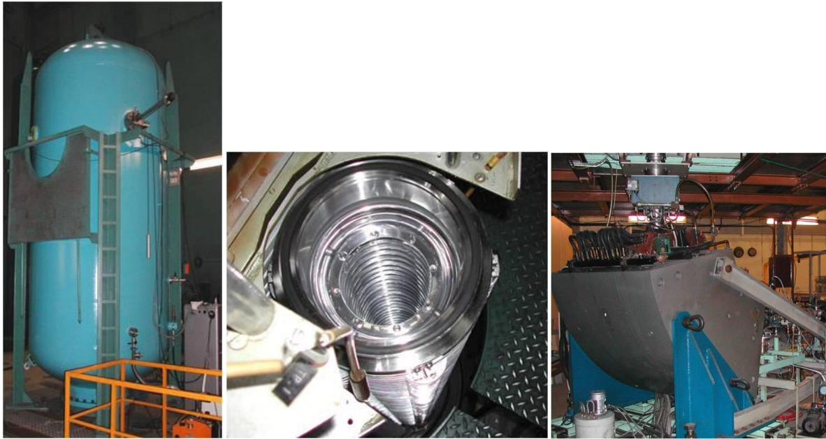
Figure III.1 : Accélérateur électrostatique Van de Graaff 4 MV de l'IPNL avec de gauche à droite la cuve externe haute de 4 m, le tube accélérateur et l'électroaimant de déflexion à 90°.
