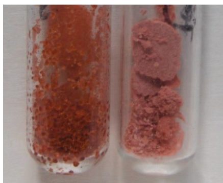
Figure 6.46: Clichés du nitrate de cobalt hexahydraté commercial (à gauche) et après traitement à 70°C sous vide pendant 12 h (à droite).
