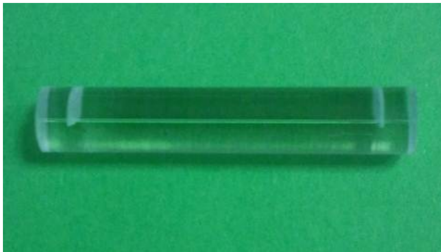
FIGURE 5.15 – Photographie d'un tube capillaire de 3 cm de longueur. On voit le cœur de 203 \mu\text{m} de diamètre et la gaine extérieure de diamètre 5.5 mm.
