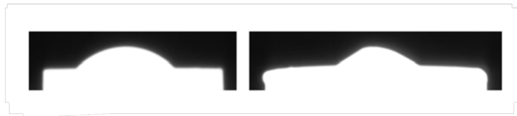
Figure 4.8: Clichés des angles de mouillage obtenus pour TiSi_2+20\%_{(vol)}SiC sur un substrat : (a) SiC CVD et (b) composite SiC_f/SiC .
