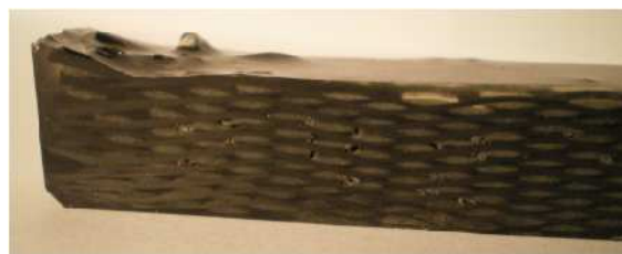
Figure I-7 : un renfort tridimensionnel (interlock) et .un composite à renfort interlock(22)
