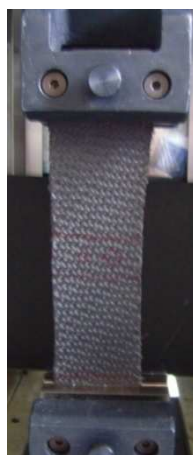
Figure II-15 Test bias : Eprouvette avant déformation
