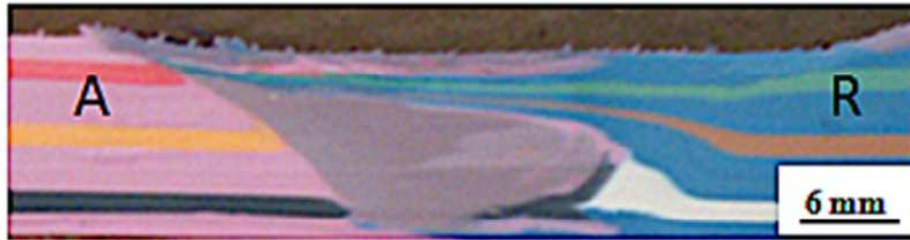
Figure I.18: Soudage des plasticines, composition rhéologique d'un cordon de soudure (différentes couleurs de plasticines) [Jemal 11].
