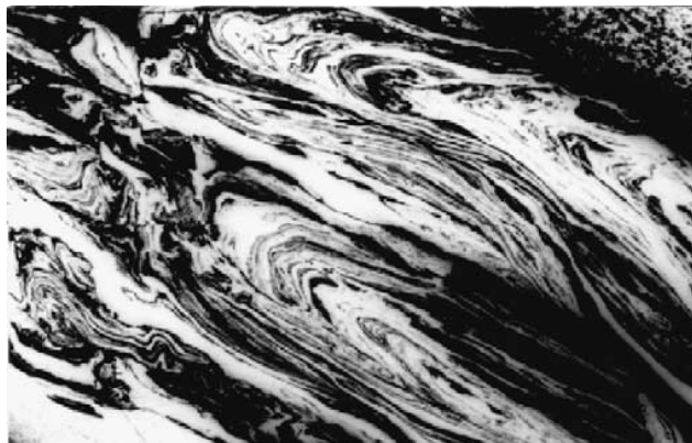
Figure I.16 : Des chevauchements de vortex de Cu et Al dans le cas du soudage bimétallique entre l'aluminium et le cuivre [Guerra et al. 03].
