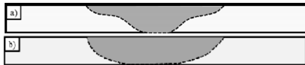
Figure III.23: Illustration schématique de la forme du noyau: a) forme concave; b) forme convexe [Gemme et al. 10].
