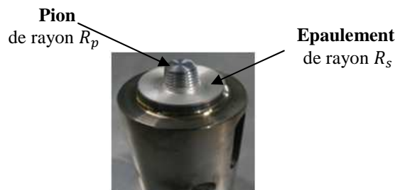
Figure I.1 : Outil de soudage conçu par l'Institut de Soudure de Metz (IS).
