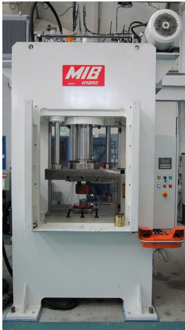
Figure C-1 : Presse utilisée dans les essais de poinçonnage
