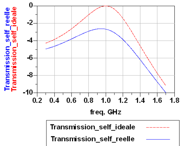
Figure II-4 : Coefficient de transmission |S_{21}| en dB, RA avec des composants idéaux et RA avec une inductance réelle de facteur de qualité égal à 10.
