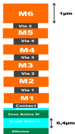
Figure III-21: Empilement de la technologie SOI 130 nm de STMicroelectronics.
