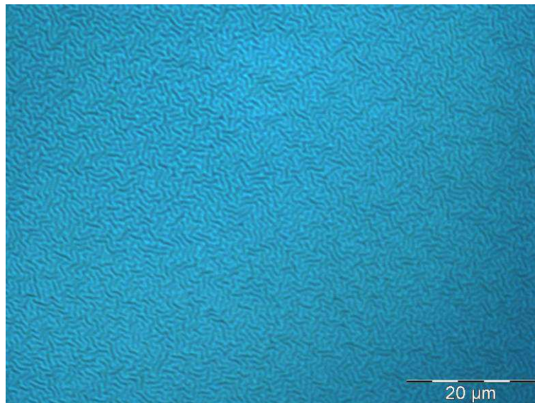
Figure 200 : Observation par microscopie optique de la surface du PDMS après un traitement plasma-O 2 de 1 min pour une puissance de 100 W
