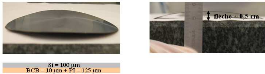
Figure 84 : Photo d'un substrat Si ( wafer 100 mm) collé par du BCB sur un substrat PI puis aminci à une épaisseur de 100 µm par abrasion mécanique
