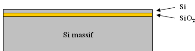
Figure 113 : Architecture d'un substrat SOI
