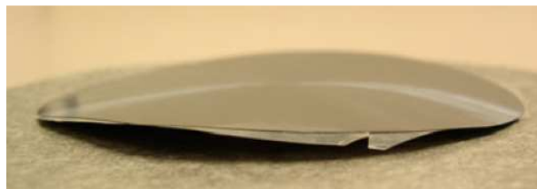
Figure 83 : Photo d'un substrat Si ( wafer 100 mm) collé par du BCB sur un substrat PEN puis aminci à une épaisseur de 100 μm par abrasion mécanique [Byun'10]
