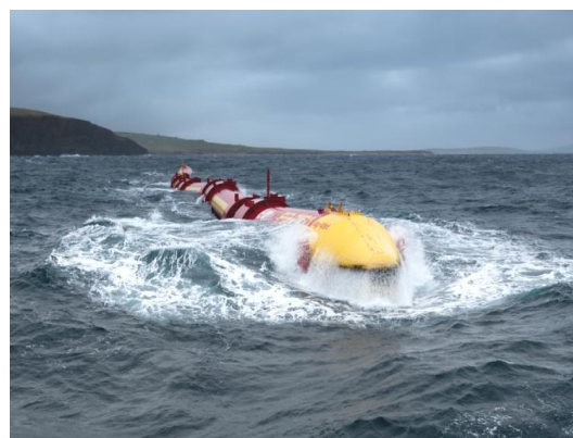
Figure I-8 : Le Pelamis développé par la société Pelamis Wave Power possède une puissance nominale de 750 kW. Source : www.pelamiswave.com
