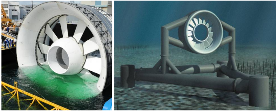
Figure I-18 : Turbine OpenCenter de la société irlandaise OpenHydro. Source : www.openhydro.com .
