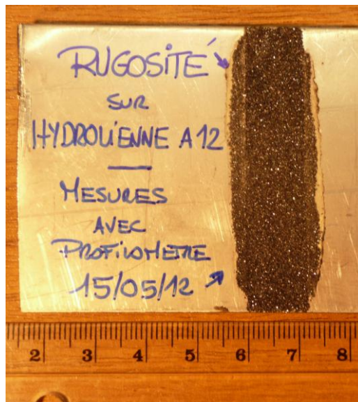
Figure IV-17 : Epreuve utilisée pour la caractérisation au profilomètre des rugosités de bord d'attaque.
