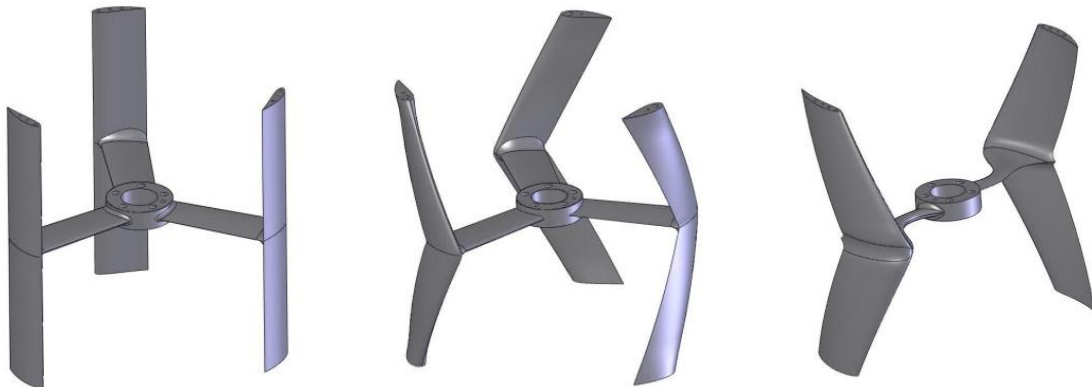
Figure I-26 : Différentes variantes de la turbine Achard.
