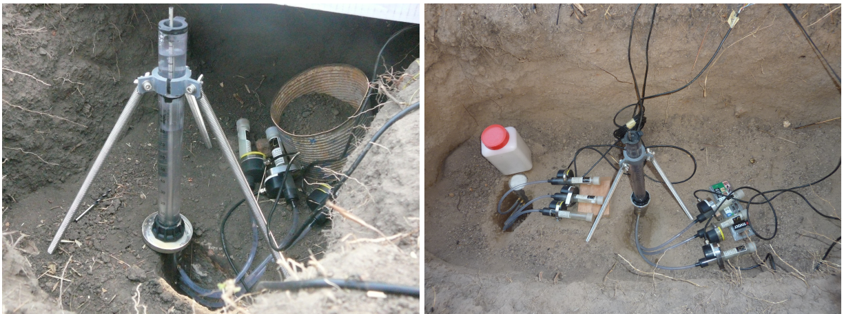
FIGURE 5.11 – Essais d'infiltrométrie avec tensiomètres sur le bassin versant de l'Ara, décembre 2010
