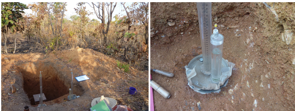
FIGURE 5.7 – Essais d'infiltrométrie à disque sur le bassin versant de l'Ara, décembre 2010
