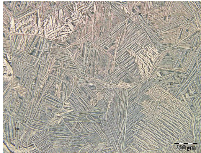
Figure II-10 : Micrographie optique en lumière blanche d'une microstructure lamellaire de Zircaloy-4 après une attaque chimique
