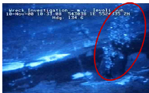
Figure I.7 : Rejet de styrène observé par la Marine Nationale à la suite du naufrage du Ievoli Sun
