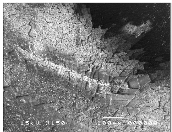
Figure III-24 : Analyse MEB de la membrane osm-ESPA au point C à la fin de la filtration (X 150)
