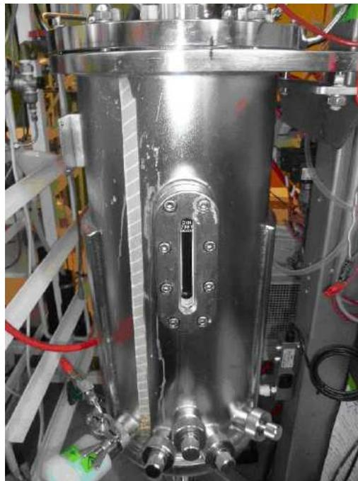
Figure 2.3 – Fermenteur de 20 L utilisé dans les travaux de [Gabelle et al. \(2012\)](#).
