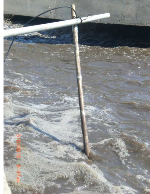
Figure 2.3.19 : Sonde d'oxygène pour la mesure en continue de la concentration d'oxygène
