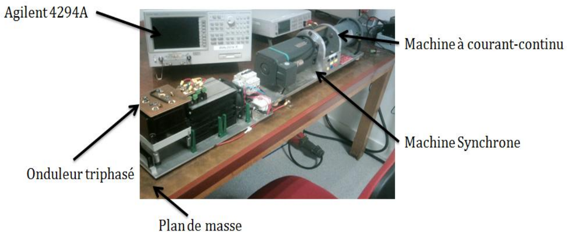
Figure.11 Identification de l'onduleur simplex
