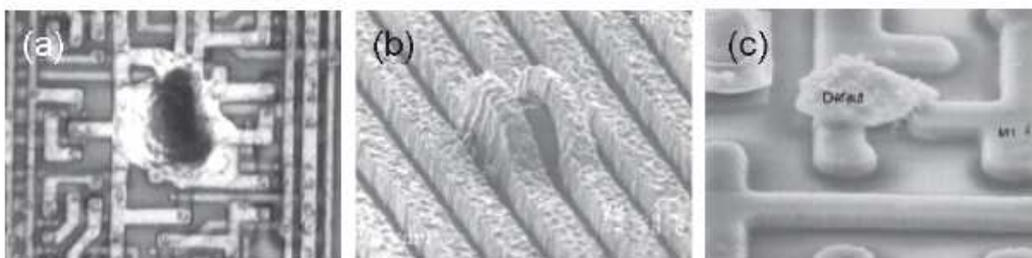
**Figure 1.6 :** Exemples d'effets néfastes liés à la présence de particules lors de la production de circuits imprimés (a) Particule prise dans un dépôt métallique. (b) Gêne stérique provoquée par une particule (c) Particule posée sur le composant en position de court circuit [10]
