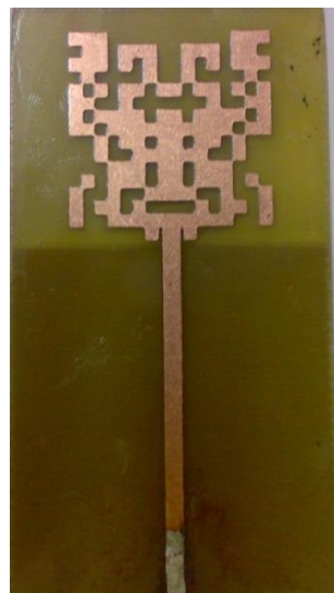
Figure II.18. Photographie de l'antenne réalisée
