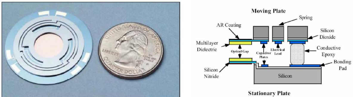
Figure 2.19 : Exemple de filtre Fabry Pérot réalisé par micro-usinage de volume, à l'aide d'une gravure DRIE. [Palmer 2006]
