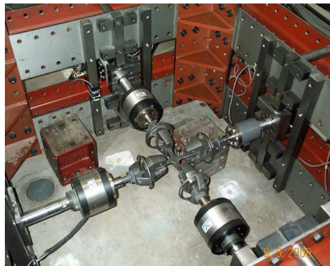
Figure 2.2. Dispositif d'essais biaxiaux Smits et al., 2006
