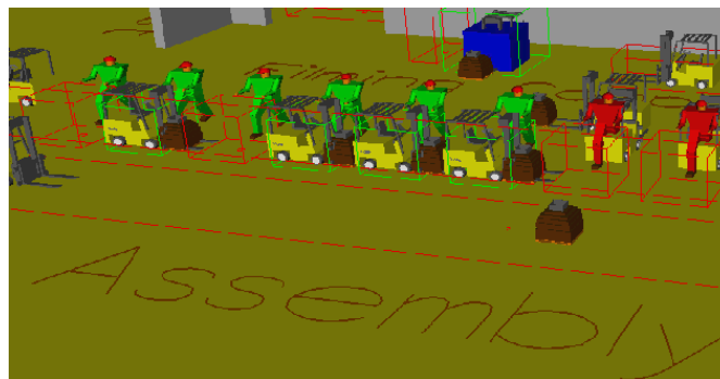
FIGURE 1.6 – Exemple d'une ligne d'assemblage manuel utilisant des transpalettes comme système de transport (copie d'écran d'un modèle de simulation sous Automod)
