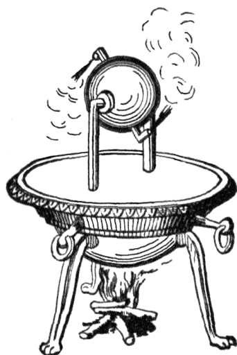
FIGURE 1.2 – L'Eolipyle d'Héron d'Alexandrie
