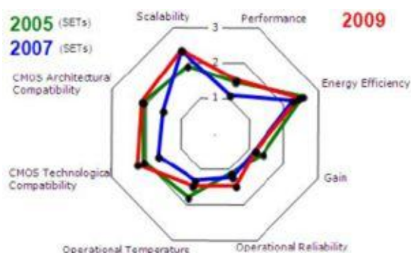
Figure 1-3 Graphique montrant l'évaluation du SET par l'ITRS. La notation va de 1 à 3 indiquant respectivement des performances moins bonnes et meilleures que le MOS ultime dans le critère correspondant (Anon., 2009)
