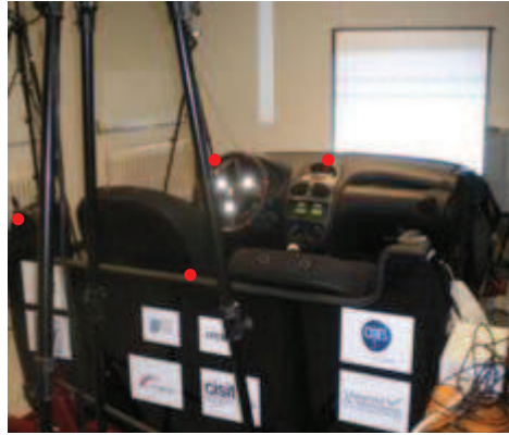
Fig. 39 : Position des marqueurs sur la maquette (en rouge) et sur le volant (en blanc)
