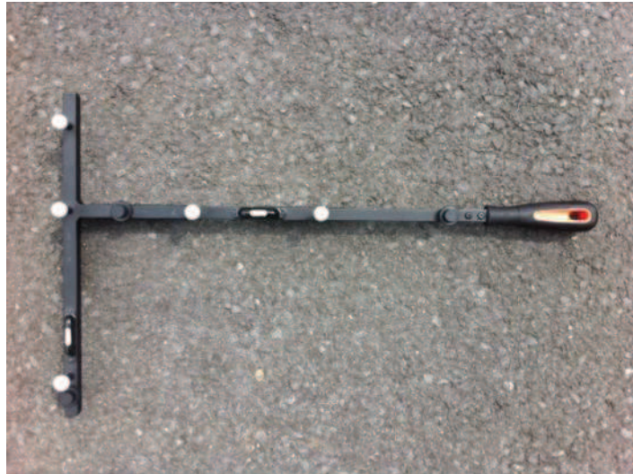
Fig. 46: Baguette de calibration des caméras Vicon®
