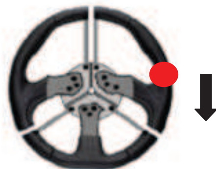
Fig. 66: Interface visuelle des tests isométriques. En rouge la position où la main doit être positionnée, la flèche noire indiquant le sens d'application de la force sur le volant
