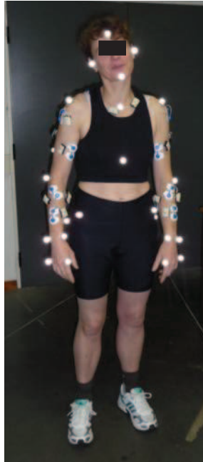
Fig. 63: Sujet équipé des marqueurs Vicon et des électrodes EMG.
