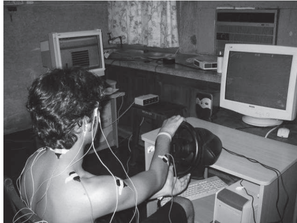
Fig. 32 : Instrumentation d'un sujet lors d'un geste de tourner le volant (Balasubramanian & Adalarasu, 2007).
