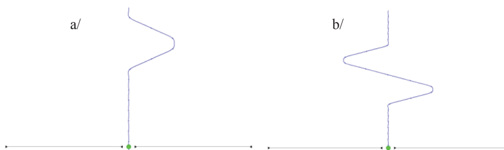
Fig. 50: a/ Configuration de d'angle au volant simple à droite et b/ droite / gauche
