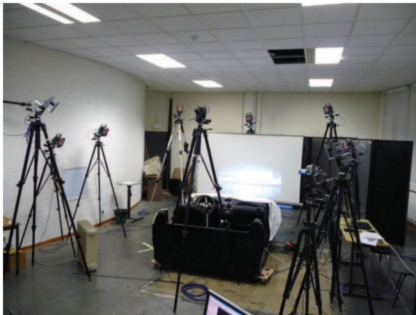
Fig. 45 : Disposition des 10 caméras autour de la maquette automobile
