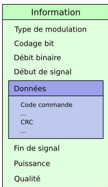
Figure III-9: Paramètres permettant de reconstruire le signal analogique – type de données « INFORMATION »
