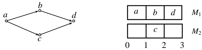
Fig. 4.1 – Ordonnancement d’un graphe de précedence avec 4 tâches unitaires : les tâches a , b et d s’exécutent sur la machine M_1 et la tâche c sur la machine M_2 .
