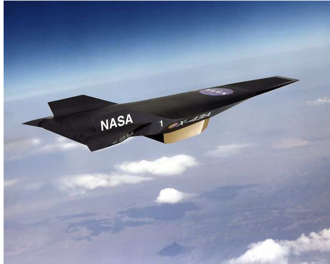
Figure 2 : X-43 Scramjet, avion sans pilote de la série Hyper-X, largué d'un avion-porteur, NASA, 2004
