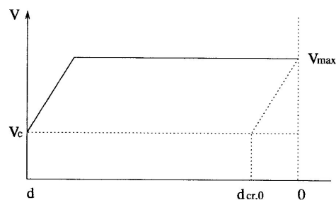
Figure 29 : Profil de la vitesse pour le plus petit coût total sans contrainte de vitesse
